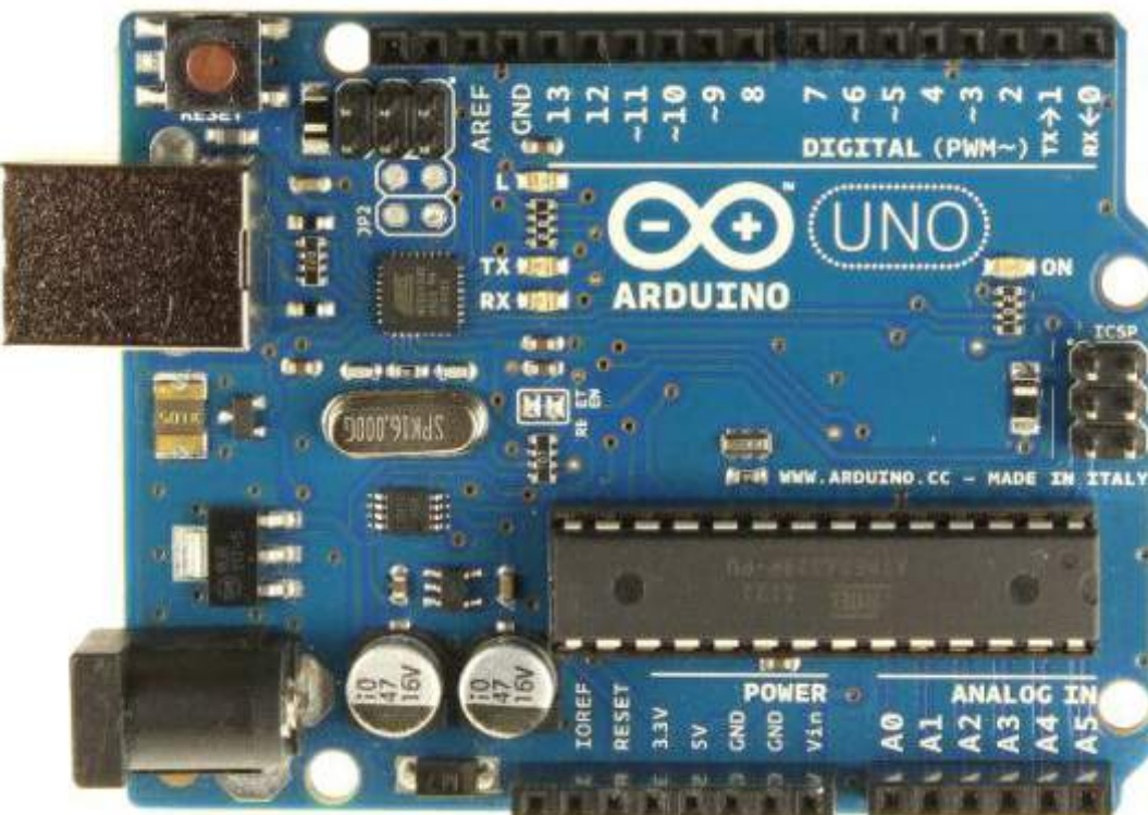
Imagen 1 Tarjeta Arduino UNO R3 Fuente: (Arduino, 2014)
