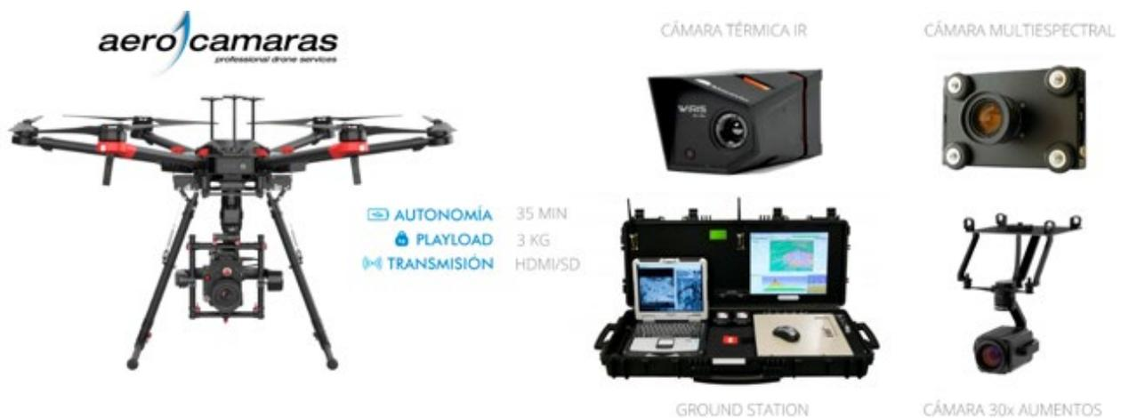
Fig. 2. Equipamiento de Drones para trabajos de fotogrametría.
