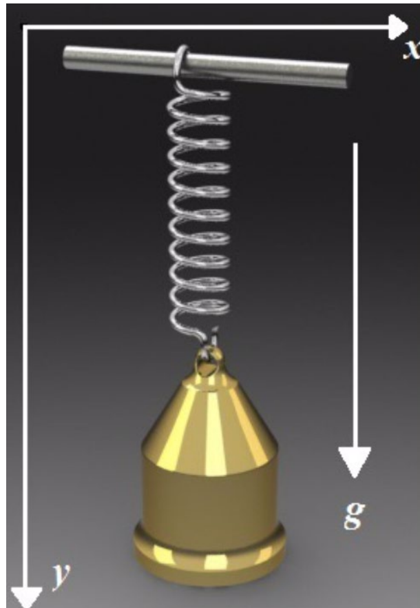
Figura 1: Sistema mecánico masa-resorte.
