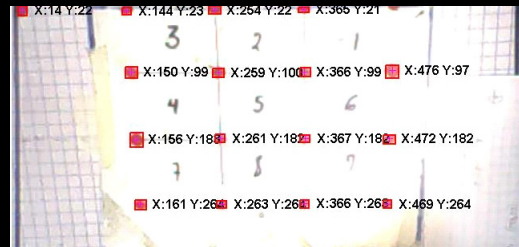
FIGURA 4. Procesamiento con algoritmo en Matlab con la cámara digital. Se muestra las coordenadas de cada punto rojo del tablero.
