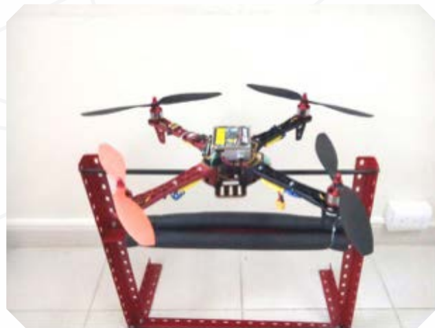
Figura 4. Cuadricóptero montado en una base para pruebas de estabilización de vuelo
