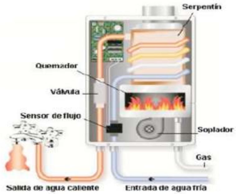
Fig. 3 Esquema de un calentador de paso a gas
