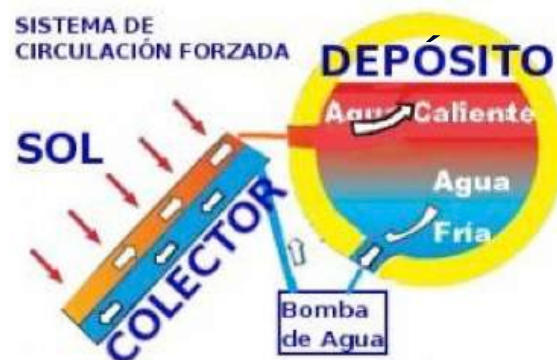
Fig. 5 Esquema calentador solar de depósito
