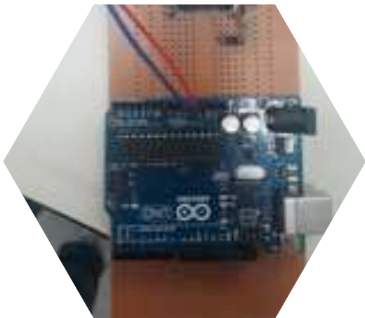
Fig. 5 Circuito de control por medio de Arduino
