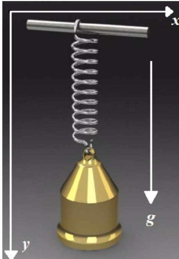
Figura 1: Sistema mecánico masa-resorte.
