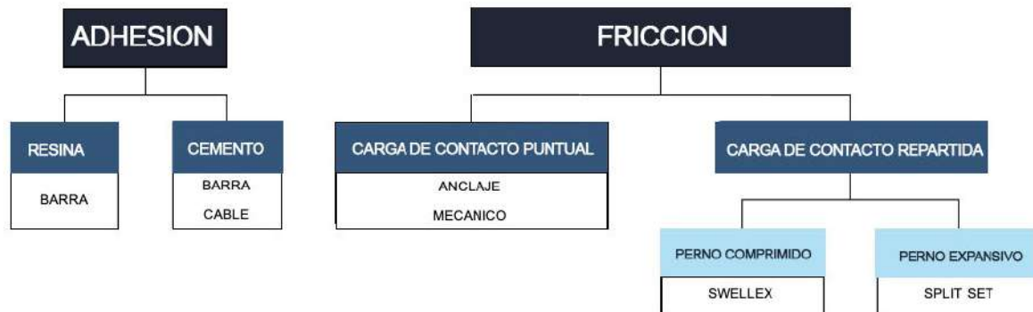
Esquema 5.11. Clasificación de los pernos de anclaje y varillas por su “Característica de anclaje”
