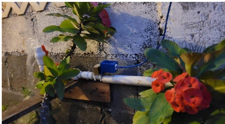
*Nota.* En la imagen se muestra el funcionamiento del adaptador receptor para electroválvula de agua de 1/2 pulgada energizada a 12 voltios, utilizando la tecnología Power Overt Ethernet aplicado en un control de riego.
