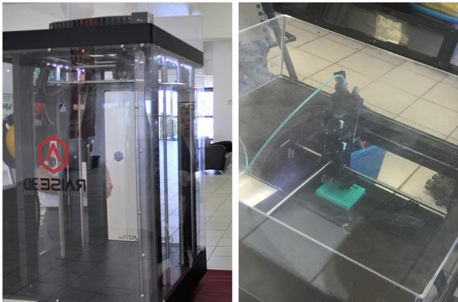
*Nota.* Se puede observar en esta imagen el modelo Raise Pro 3 de la impresora, la cual se utilizó para la impresión de la carcasa del prototipo, así como su proceso de impresión, utilizando el material acrilnitrilo, butadieno estireno o ABS es
