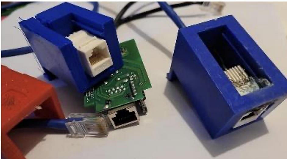
*Nota.* En la imagen muestra el ensamblaje de los componentes del adaptador, tanto la tablilla electrónica y los adaptadores RJ45 hembra, quedando exante en sus cimentaciones diseñadas previamente.
