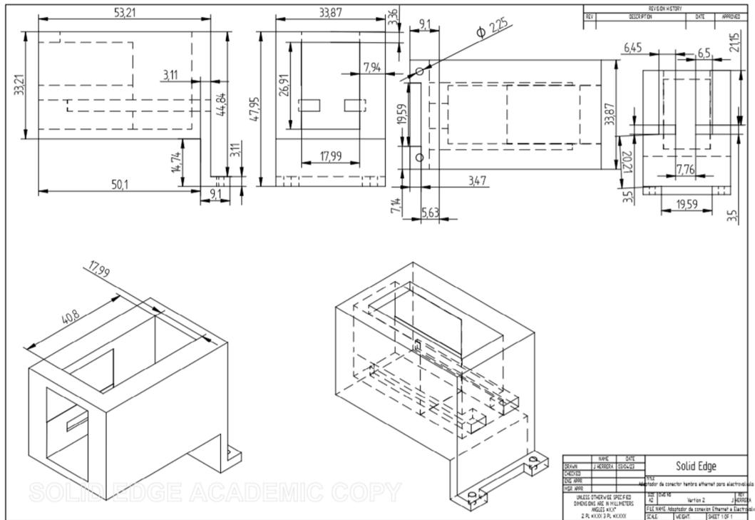
*Nota.* En la imagen se presenta el modelo del adaptador dibujado en 2D, digitalizado con el software de diseño *SOLID EDGE* el cual muestra las dimensiones exactas.
