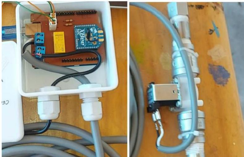
*Nota.* Nodo coordinador con válvula de riego adaptado de A. Romero Rodríguez y C.A., Rubio Cheon, 2022, *Diseño e implementación de prototipo de red inalámbrica de sensores* [Tesis de grado, Universidad Rocado Palma]. <https://repositorio.>
