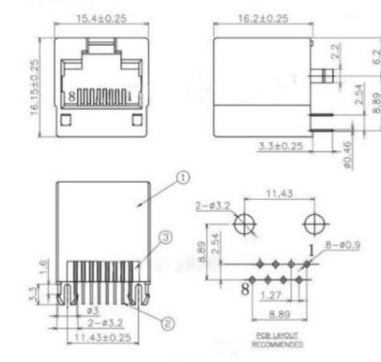
*Nota.* Del mismo modo se diseñó el conector Rj45 hembra basándose el protocolo IEEE 802.3at, para la identificación de hilos y así su adaptación a la tablilla electrónica, el cual se presenta en esta imagen.
