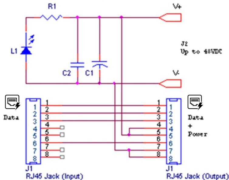
*Nota.* En la siguiente imagen se muestra el diseño del diagrama electrónico dentro de su configuración PoE, utilizando IEEE 802.3, los cuales muestran que 4 hilos son los conductores del voltaje y los demás para la transmisión de los datos
