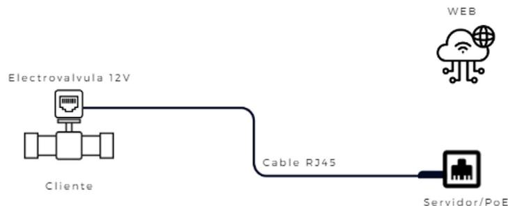
*Nota.* En esta imagen se muestra el esquema visual de la topología de conectividad de la electroválvula dentro de un entorno de internet de las cosas con la topología cliente / servidor
