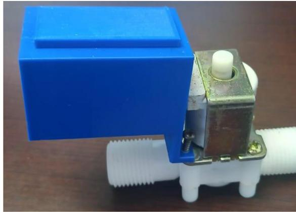
*Nota.* En la imagen el adaptador receptor terminado para electroválvula de agua de 1/2 pulgada energizada a 12 voltios, utilizando la tecnología Power Overt Ethernet.
