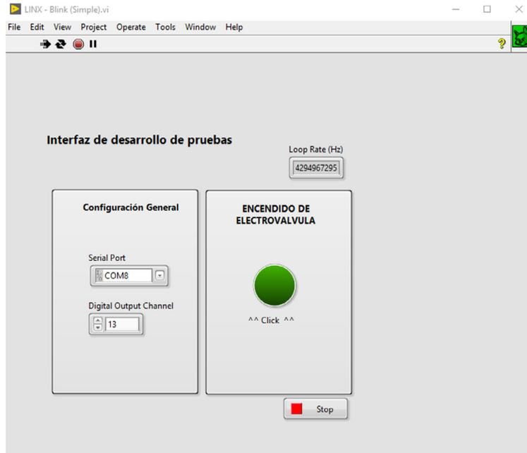
*Nota.* En la imagen muestra el software que se diseñó en LabVIEW para las pruebas de control de operatividad de electroválvula y tener una interfaz de pruebas de protocolo.
