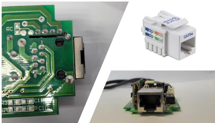
*Nota.* Se puede observar los componentes internos del adaptador, los cuales se iniciaron con el ensamble de un conector rj45 hembra para posteriormente pasar a la adaptación de una tablilla electrónica soldando con el conector rj45 utilizando el protocolo IEEE 802.3at.
